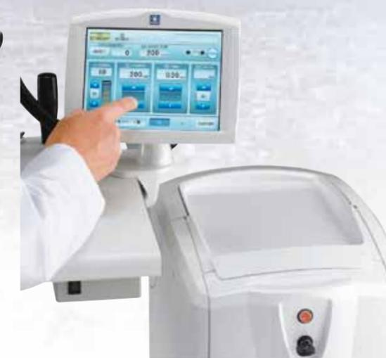
2 режима работы сканирующих паттернов – быстрое автоматическое нанесение коагулятов паттерна и режим с программируемой скоростью нанесения каждого коагулята сканирующего паттерна (контроль ситуации после каждого импульса паттерна). Режим быстрого сканирования удобен для быстрой безболезненной периферической лазеркоагуляции; режим медленной последовательной лазеркоагуляции с функцией приостановки сканирования в любой точке для точных безопасных манипуляций в парамакулярной области.
